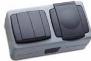
İkili Nemliyer Komütatör + Kapaklı Topraklı Priz 36064203 10 AX, 250 V~ / 16 A, 250 V~ EN 60669-1 / IEC 60884-1 Kutu / Koli Adedi - 6 / 60
